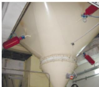
Часто вибродница устраняют зависания в нижней части бункера, при этом оставляя зависания на вертикальных стенках. С помощью пушек «ИСТА-3» эта проблема может быть решена
